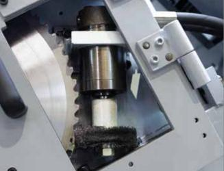
\_ Automatische Schmierung aller beweglichen Teile zur Gewährleistung eines korrekten Betriebs. Die Schmierung kann über die Maschinensteuerung zeitlich vorprogrammiert werden.
