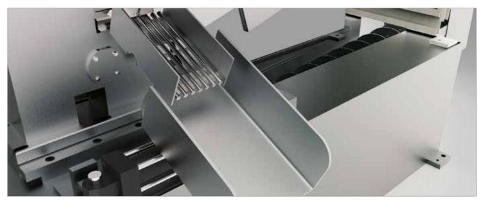
\_ Automatischer Rückzug des Zuführers nach jedem Schnitt um eine Reibung mit dem Material zu vermeiden.
